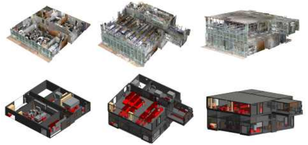
그림 7. 스캔 데이터와 BIM 모델 비교
