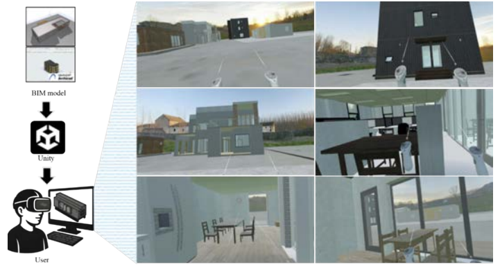
[그림 4] 설계 단계에서의 BIM-VR 기반 건축 워크스루
